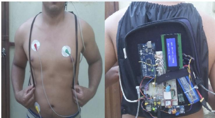
**Módulo de aquisição acoplado no paciente analisado**
